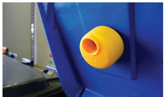
Sensoren zur Füllstandskontrolle bei Abfallgebilden
